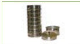
Figure 4: Kit d'analyse au tamis
