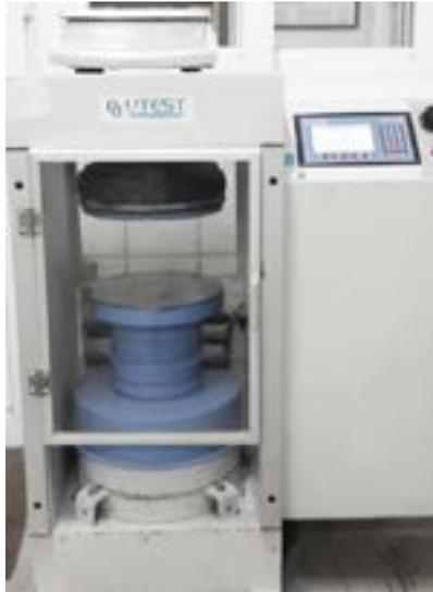
*Figure 9: Machine à compression de béton*
