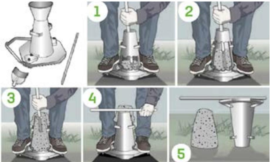
Figure 6: Essai d’affaissement (Slump)
